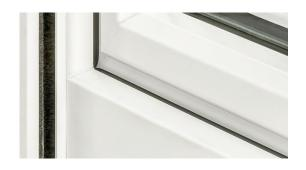
Limpiar los **perfiles** que componen la ventana sólo con agua y jabón líquido neutro, aplicados con un paño. Evitar el uso de productos abrasivos (detergentes en polvo, estropajos metálicos...) que puedan rayar la superficie de los perfiles.
